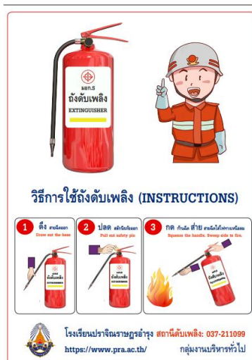
ภาพที่ 9 สติ๊กเกอร์คู่มือการใช้ถังดับเพลิง
